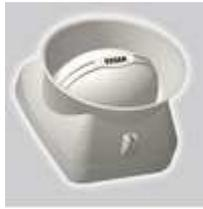
La gamme de diffuseurs sonores est conçue suivant les exigences des normes NF EN 54-3, NF S 61-936 et NF S 32-001. Étudiés pour recevoir indifféremment les diffuseurs sonores 10110DS ou 10130DSME sur un socle unique sans modification de câblages. L'interchangeabilité des diffuseurs sonores s'effectue simplement par un système intégré de connexion embrochable.
